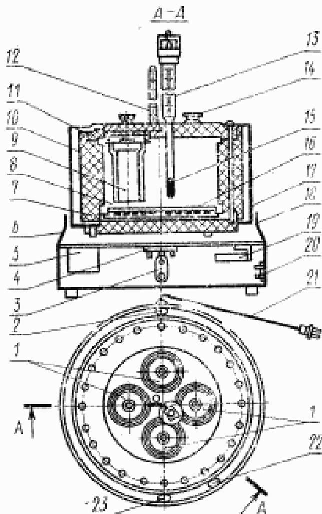
1,14—крышки; 2—клемма заземления; 3,20—розетки штепсельные; 4—плата клеммная; 5—трансформатор; 6—основание; 7,11—теплоизоляция из асбестового листа; 8—баня металлическая; 9—бомбочка металлическая; 10—обязка Ньютона; 12—термометр контрольный; 13—термометр контактный; 15—сплав Милот; 16—электронагреватель; 17—корпус; 18—теплоизоляция из асбестового листа; 19—реле; 21—шпур с винтом; 22—переключатель; 23—сигнальная лампа.
